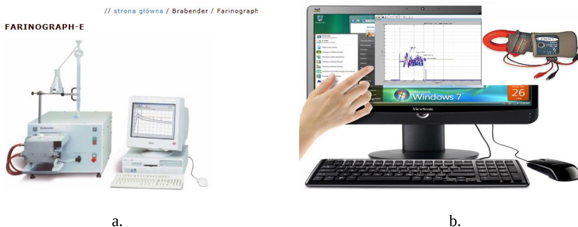
Figura 1: a. Farinograful Brabender; b. Aparat portabil de înregistrare a curentului consumat la frământarea aluatului
